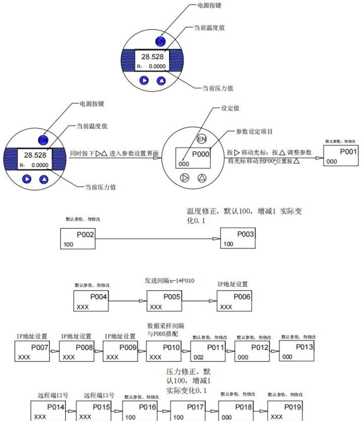
参数更改完后必须将光标移动到 P0\*\* 的下划线的位置, 再次按▲键进入下一参数, 同时按下▶键、▲键才能保存。若不需要修改参数值, 在当前修改参数页面同时按下▶键、▲键退出参数设定界面。
