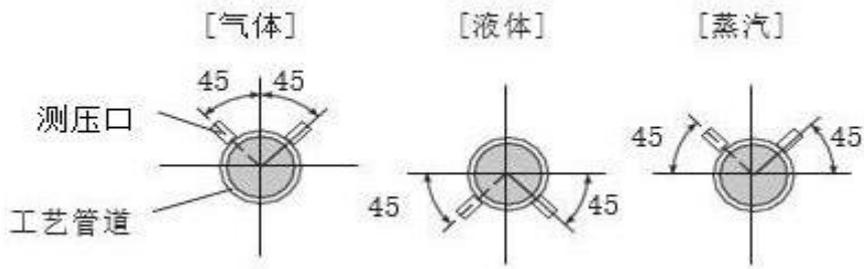
如果冷凝水(或气体)积聚在管道中,应定期打开排水(或通风)塞将其清除。然而,这将在压力测量中产生瞬时干扰,因此有必要定位分接头和确定管道的路线,以便在引线中产生的任何外来液体或气体自然返回到工艺管道中。
