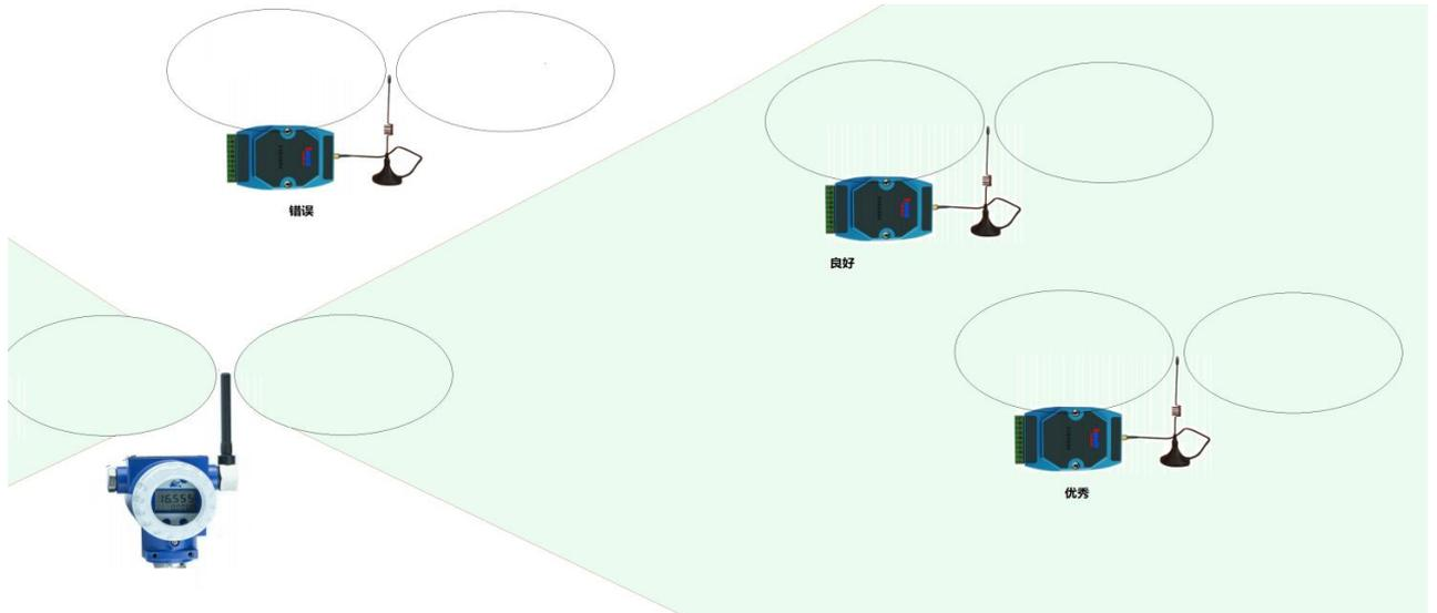
(6) 天线的定位需要远离金属物体，当距离大于 30 厘米，金属物体的影响变得较弱，无线设备安装时离开建筑物、金属设备一定距离(建议 0.5-1 米)。
