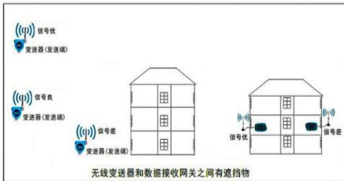
注：吸盘天线应竖直向上安装，高度越高越好。如天线安装在墙边铁皮建筑边（如上图）等，应离墙面大于20cm。
