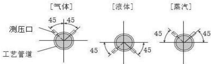
如果冷凝水(或气体)积聚在管道中,应定期打开排水(或通风)塞将其清除。然而,这将在压力测量中产生瞬时干扰,因此有必要定位分接头和确定管道的路线,以便在引线中产生的任何外来液体或气体自然返回到工艺管道中。
